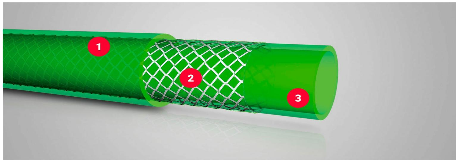
Manguera fabricada por extrusión de compuestos vinílicos, con malla de hilos de poliéster
