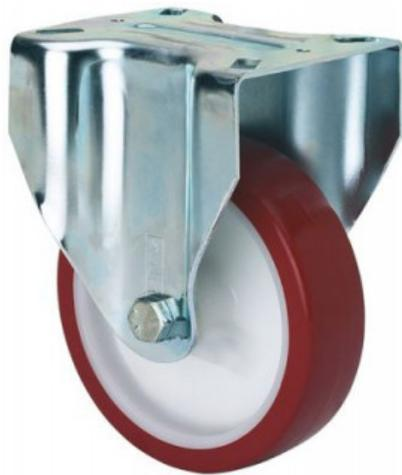
Ruedas con núcleo de poliamix blanco y banda de poliuretano marrón inyectado de dureza 95° shore A. Especialmente indicada para soportar cargas hasta 300 Kg.
