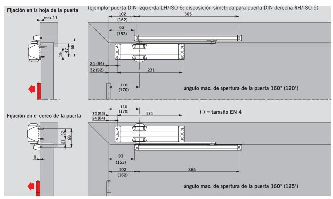
Dependiendo de las condiciones estructurales, el ángulo de apertura de la puerta puede limitarse. Es recomendable instalar el limitador de apertura o un tope de puerta en este punto. En caso de las puertas cortafuego se debe instalar siempre un tope de puerta.
