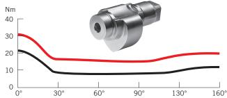
La leva en forma de corazón y el mecanismo de accionamiento lineal del TS 90 Impulse, asegura que la resistencia a la apertura disminuya casi inmeditamente al abrirse la puerta. Niños y personas mayores o discapacitadas, pueden abrir la puerta sin esfuerzos y sin necesidad de aplicar mucha fuerza.
