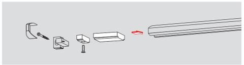
El limitador de apertura está adaptado para insertarse en la guía deslizante.
