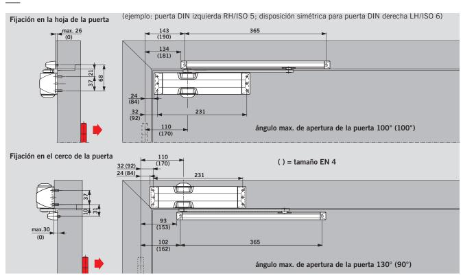
Dependiendo de las condiciones estructurales, el ángulo de apertura de la puerta puede limitarse. Es recomendable instalar el limitador de apertura o un tope de puerta en este punto.
