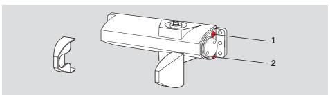
La velocidad de cierre del TS 90 Impulse se ajusta en dos zonas independientes en las dos válvulas indicadas.
