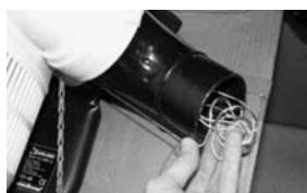
Inserite il cavo in rame all'interno del tubo (ricurvo) di uscita dell'aria.
