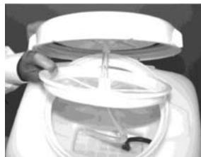
Per la fumigazione di liquidi, il tubo di silicone trasparente deve rimanere collegato dal tappo del serbatoio fino all'angolo della base
