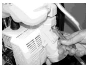
Démontez le réservoir pour changer la base d'admission de liquides (monté à l'origine), par la de poudre. Pour cela, dévissez les
