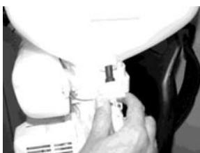
Saque el tubo negro del depósito desenroscando la cánula de salida.
