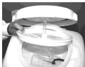
Para a pulverização de líquidos, o tubo de silicone transparente deve ser ligado da parte superior do tanque até o canto da base da admissão
