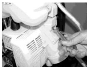
Desmonte el depósito para cambiar la base de admisión de líquidos (montada en origen) por la de polvo. Para ello desatornille las
