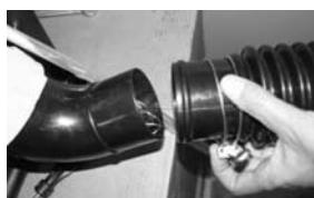
Connectez les tubes à la machine directement (avec le câble en cuivre dans l'intérieur).
