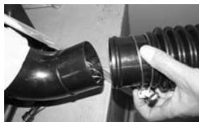
Conecte el conjunto de tubos a la máquina directamente con el cable de cobre en el interior.
