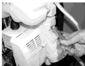
Smontate il serbatoio per sostituire la base d'immissione (montata in origine) per i prodotti liquidi e/o in polvere. A tal scopo svitate i
