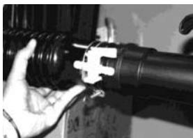
Acople el tubo flexible (3) al tubo recto (1) mediante la abrazadera con el grifo.
