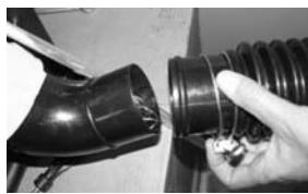
Collegate il connettore di tubi direttamente alla macchina (con il cavo in rame all'interno).
