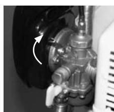
Portate la levetta dell'aria in posizione di "chiuso".
