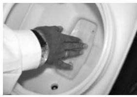
Presione la base de admisión de líquido para que salga por abajo. Observe que en la base de admisión existe una flecha y la palabra ENGINE que indican la posición correcta de la base.
