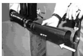
Introduzca el asa (8) en el tubo recto (1) y apriete los tornillos para que el asa quede fija en el tubo.
