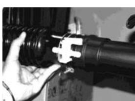
Collegate il tubo flessibile (3) al tubo dritto (1) mediante il morsetto del rubinetto.
