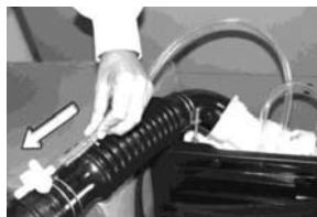
Il tubicino di silicone trasparente che proviene dalla pompa deve essere collegato alla chiave del morsetto.
