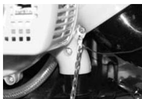
Montare la catena con il cavo in rame nella vite presente sul gomito di uscita dell'aria e lasciatela sciolta dall'altro estremo in modo che possa sempre toccare il suolo mentre state utilizzando la macchina (la catena deve toccare il suolo costantemente, così da generare massa e poter dissipare la carica eletrostatica accumulatasi all'interno del tubo).
