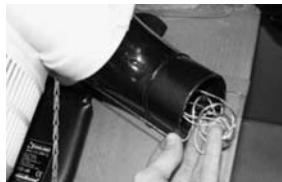
Introduzca el cable de cobre dentro del codo de salida del aire.
