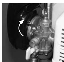
Coloque la palanca del aire en la posición cerrado.
