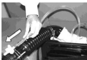
Connectez le tube de silicone transparent (7) dès la clé de l'anneau jusqu'à l'embouchoir (5).
