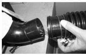
Ligue o tubo de montagem na máquina diretamente com fio de cobre no interior.
