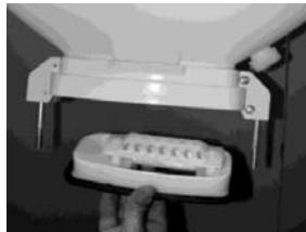
Introduisez la base d'admission de poudre en pressent jusqu'à que reste fixe à sa place. Installez le réservoir à nouveau.
