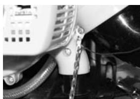
Placez la chaîne avec le câble en cuivre dans la vis du coude de sortie d'air et, lâchez-la de l'autre extrémité, pour
