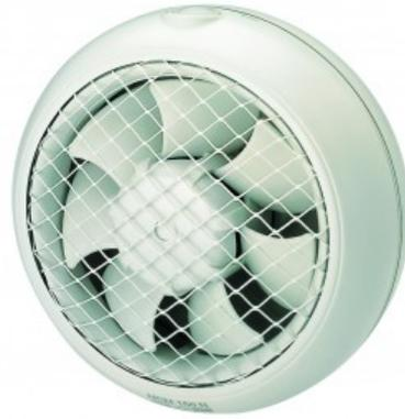
Ventiladores helicoidales para instalar en cristal o pared, con carcasa de plástico ABS, persiana de sobrepresión incorporada, rejas de seguridad en aspiración y descarga, motor 230V-50Hz, clase B, IPX4, Clase II, con protector térmico mediante fusible.
