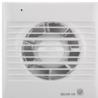
Ventiladores helicoidales extraplano, con caudal aproximado de 100 m<sup>3</sup>/h, compuerta antirretorno incorporada, luz piloto de funcionamiento, motor 230V-50Hz, con rodamientos a bolas, IPX4, Clase II, con protector térmico, para trabajar a temperaturas de hasta 40°C.
