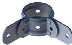
Tensor de alambre fabricado con fleje laminado en frío de calidad DC-01. Una vez ensamblado se le aplica un proceso de zincado electrolytico para obtener una protección total sobre la pieza.
