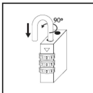
Después de abrirlo debe girar el arco 90° y presionar hacia dentro. Manteniendo presionado el arco, cambiar la combinación y después soltar el arco.
