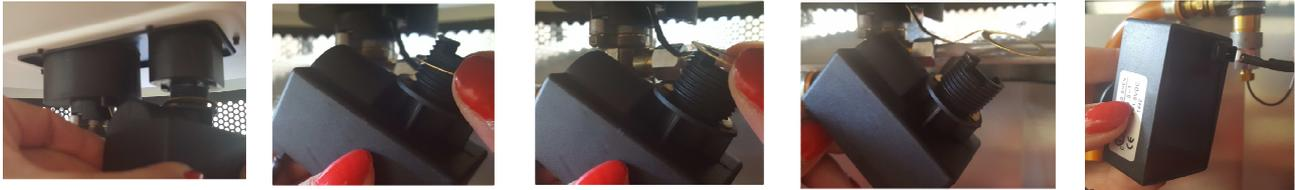
CUANDO RECIBA EL NUEVO CAJETÍN, DEBEMOS CONECTAR EL CABLE QUE CONECTA EL PIEZO ELÉCTRICO, COLOCAR DE NUEVO LA ANILLA Y VOLVER A ENROSCAR, COMPROBANDO QUE ESTÉ BIEN ADAPTADO Y SUJETO.
