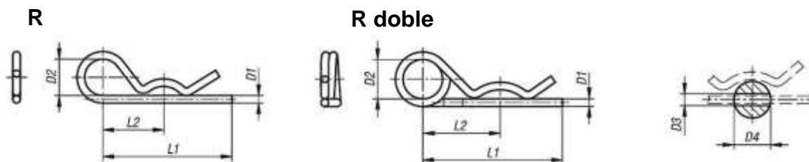
El pasador “R” se ha fabricado tomando como base la normativa DIN 11024; el pasador “R doble” se ha fabricado siguiendo las indicaciones de la normativa DIN 11024 donde se especifican los siguientes rangos de medidas (en milímetros):
