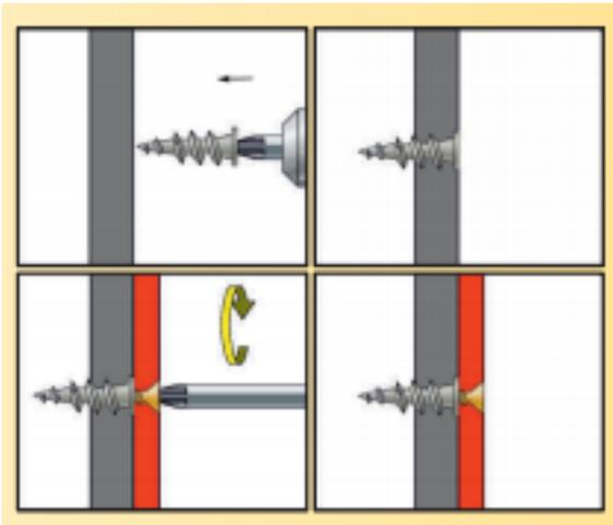
Especial para insertar en paredes secas (pladur).
