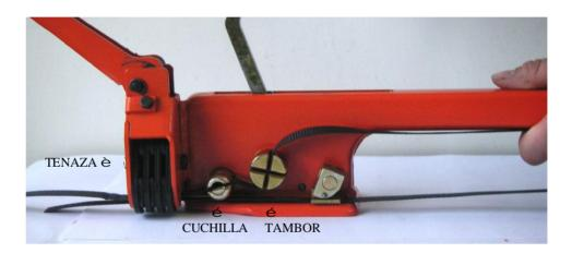
Se procede a tensar un poco a mano para introducir la grapa ó precinto metálico en la tenaza adecuado para la medida del fleje que estamos utilizando, 13 ó 16 mm. Cerciorarse que el precinto coja las dos bandas de fleje como en la siguiente figura.
