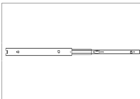
Para volver a instalar los cajones, simplemente Coloque el cajón sobre las correderas y empújelo hacia adentro por completo.
