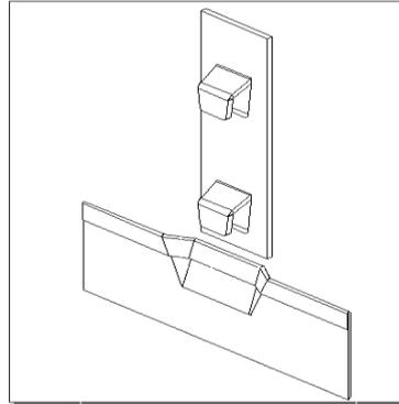
(a): pestaña de la barra de bloqueo, (b): bolsillo de bloqueo Para desbloquear la unidad, gire la llave hacia la derecha y deslice el cajón hacia afuera. Si es necesario retirar los cajones, siga estas instrucciones para retirar los cajones:
