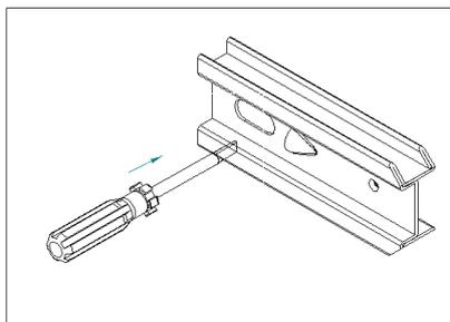
Repita el procedimiento en la otra corredera y retire el cajón. (Figura 2 y 3) Para volver a instalar el cajón, haga palanca en el tope lo suficiente como para enganchar las lanzas (3/16" a 1/4") y empuje el cajón sobre el deslizador hasta que los topes se enganchen con las lanzas.
