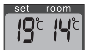
G: Vaadittu lämpötila vasemmalla, mitattu lämpötila oikealla.
