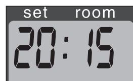
F: Quand les 4 chiffres arrêtent à clignoter, les valeurs insérées sont mémorisées.
