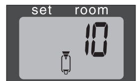
K: Wenn die FUEL-Anzeige aufleuchtet sehen Sie im Informations-Display für wieviel Minuten Sie noch Brennstoff haben.
