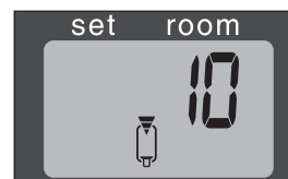
K: Kun FUEL-merkkivalo syttyy, tietonäytössä näytetään, kuinka moneksi minuutiksi säiliössä on polttoainetta.
