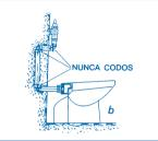
El tubo de descarga NUNCA deberá tener reducciones o ángulos bruscos, hechos con codos, ni deberá introducirse hasta el fondo de la entrada del inodoro. Esto provocaría rebosamiento de agua por las ventanas de aireación (Fig. B)
