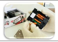
3. Pulse el pulsador "blanco", situado junto al conector microUSB, con la punta de un bolígrafo durante unos segundos, hasta que el led se ilumine en naranja.
