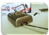
4. Antes de enroscar la antena, coja uno de los mandos, aproxímelo hasta rozar con el conector de la antena y pulse cualquiera de los botones. El led en naranja pasará a verde para confirmar la vinculación con el cerrojo. Repita los pasos anteriores para el resto de los mandos a vincular.
